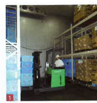
1 原料倉庫。110棚あり、約1日分の在庫を-9℃前後で保管している。周辺にある複数の外部倉庫から、必要な量だけ運んでくる
