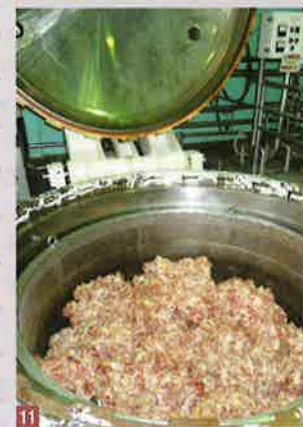
9 破砕機で原料の骨を細かく砕く 10 抽出釜は9基。熱水抽出法で骨を水と一緒に炊き、スープを抽出する。使う骨は鶏と豚のみ 11 抽出釜に投入された鶏骨。これから加水し炊き出す 12 酵素分解釜は3基。肉を原料に使い、スープを抽出する。力価が高く、少量でも濃厚な味に仕上がる 13 第2工場の場合、抽出の温度や時間などはコンピューターによる自動制御を行っている 14 抽出後は振動ふるい機で一次ろ過を行う
