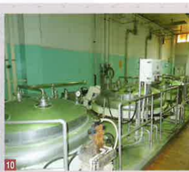
9 破砕機で原料の骨を細かく砕く 10 抽出釜は9基。熱水抽出法で骨を水と一緒に炊き、スープを抽出する。使う骨は鶏と豚のみ 11 抽出釜に投入された鶏骨。これから加水し炊き出す 12 酵素分解釜は3基。肉を原料に使い、スープを抽出する。力価が高く、少量でも濃厚な味に仕上がる 13 第2工場の場合、抽出の温度や時間などはコンピューターによる自動制御を行っている 14 抽出後は振動ふるい機で一次ろ過を行う
