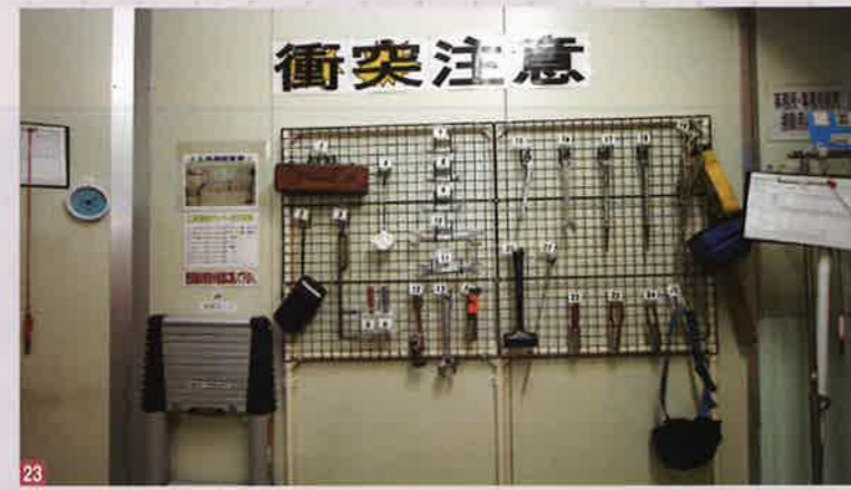
19 包装室はクリーンルーム。清浄度はクラス1000。ピロー包装機やロータリー包装機で充填する 20 チラー水の水槽で冷却。充填時に70℃ぐらいだった品温を5分程度で30℃以下まで下げる 21,22 急速凍結庫は2台。-39℃前後で凍結。12時間ぐらいで完全凍結される 23 工具の定数・定位置管理を徹底
