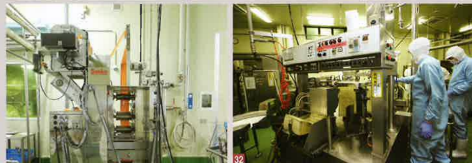
29,30 液中の金属異物を検出する金属検出機と1万2000ガウスのマグネットに通す 31 缶詰の巻き締めライン 32 業務用のカレーなどを袋詰めする自動充填包装機 33 ラーメン用調味液など5~100gぐらいの製品を袋詰めする小袋充填機
