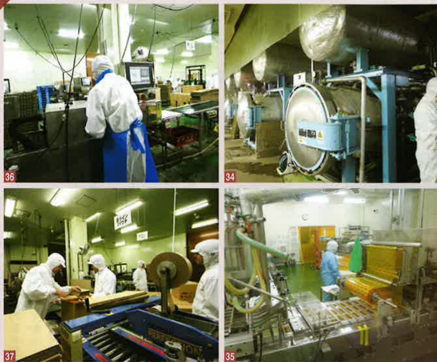
34 レトルト殺菌機は5基。袋詰めした製品を加熱殺菌する 35 固形ルー（カレー、ハヤシ、シチュー）を調味料の調合から製造する専用ラインも稼働している 36 梱包室。レトルト殺菌後、除水機で袋の表面に付着した水を取り除き、X線異物検査装置に通す 37 製品を箱詰めし、封函機で封をする
