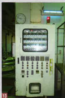
9 破砕機で原料の骨を細かく砕く 10 抽出釜は9基。熱水抽出法で骨を水と一緒に炊き、スープを抽出する。使う骨は鶏と豚のみ 11 抽出釜に投入された鶏骨。これから加水し炊き出す 12 酵素分解釜は3基。肉を原料に使い、スープを抽出する。力価が高く、少量でも濃厚な味に仕上がる 13 第2工場の場合、抽出の温度や時間などはコンピューターによる自動制御を行っている 14 抽出後は振動ふるい機で一次ろ過を行う
